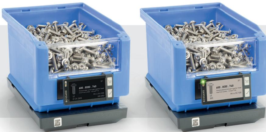
助您的物料管理迈向新高度。称重传感器随每次取料或补货实时更新库存数据。物料库存低于预设安全库存时，系统自动触发补货流程。
