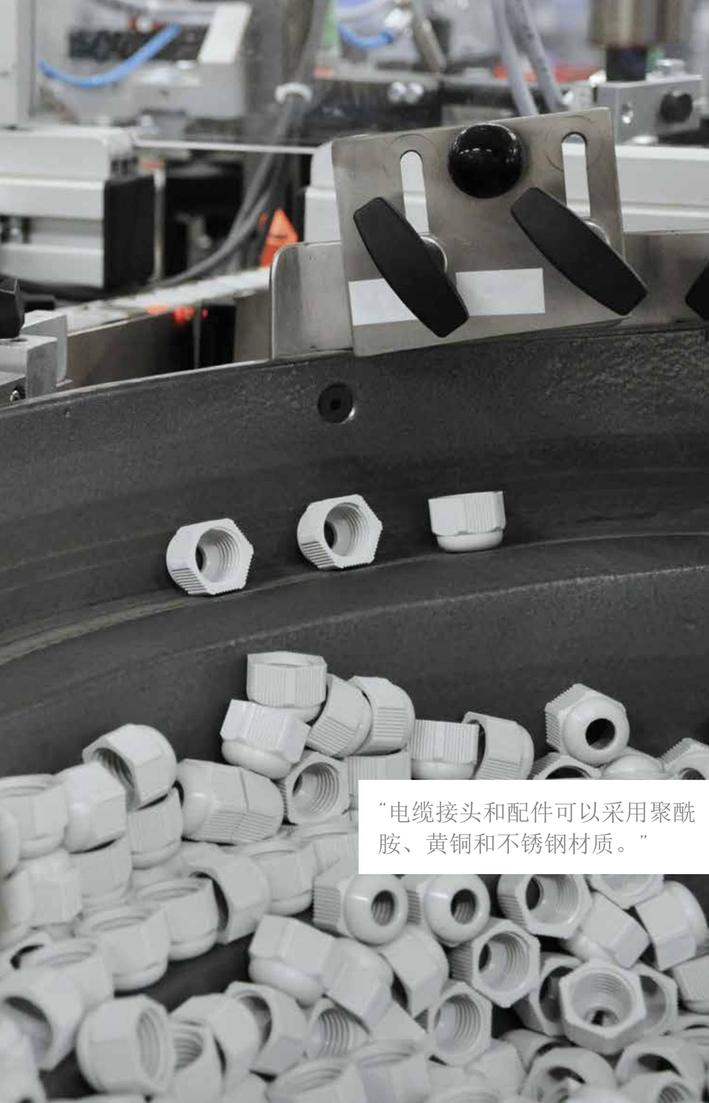
“电缆接头和配件可以采用聚酰胺、黄铜和不锈钢材质。”
