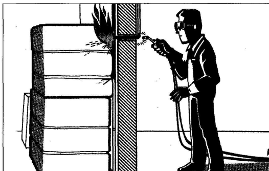
Figure 2 : inflammation au contact de conduites invisibles chauffées
