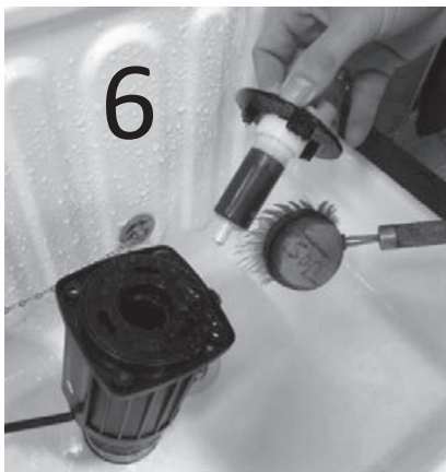
Rotor mit Wasser und Bürste reinigen
