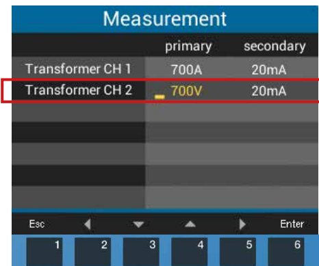
Fig.: Ventana «Measurement» (Medición) con la configuración de los convertidores de medida para el modo de medición «Potencia CC».
