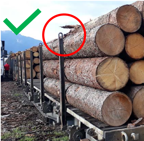
Bild 4: Korrekte Beladung der Stämme mit vollständiger Überdeckung durch die Rungen
