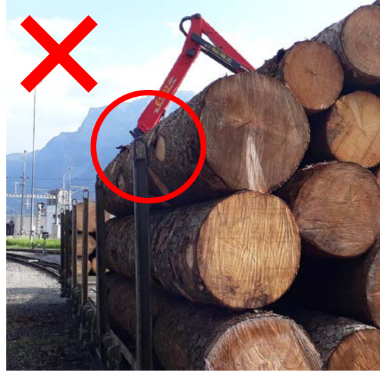
Bild 5: Unzulässige Beladung der Stämme ohne vollständige Überdeckung durch die Rungen
