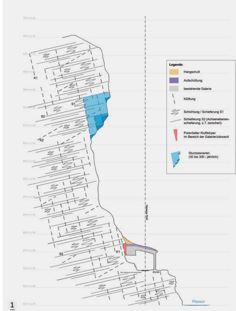
Bild 1: Geologisches Querprofil bei km 2.433 mit eingezeichneten Schichten und Klüften.
